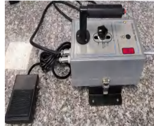
Sharp Edge Testing Machine
